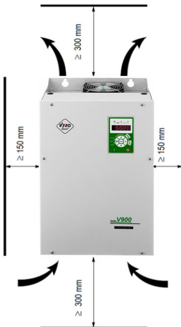
Umiestnenie meničov veľkosti C1,C2,C3
