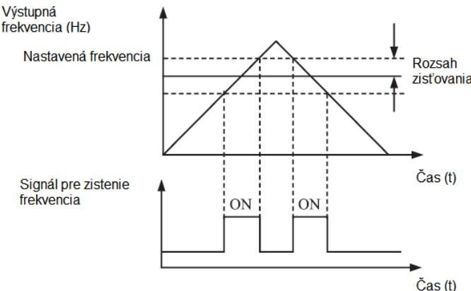
Obrázok 4-15 Rozsah detektie frekvencie
