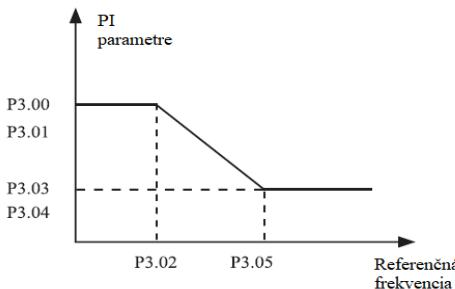
Obrázok 4-4: Vzťah medzi frekvenciou chodu a parametrami PI
