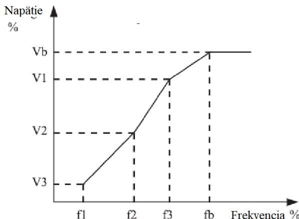
V1-V3: 1. 2. a 3. napätie; F1-F3: 1. 2. a 3. frekvencia v percentách;
