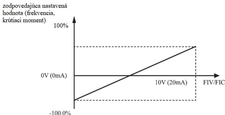
Obrázok 4-11: Vzťah medzi analógovými vstupmi a nastavenými hodnotami
