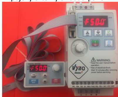
Pripojený externý ovládací panel
