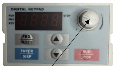
Potenciometer POT na externom paneli
